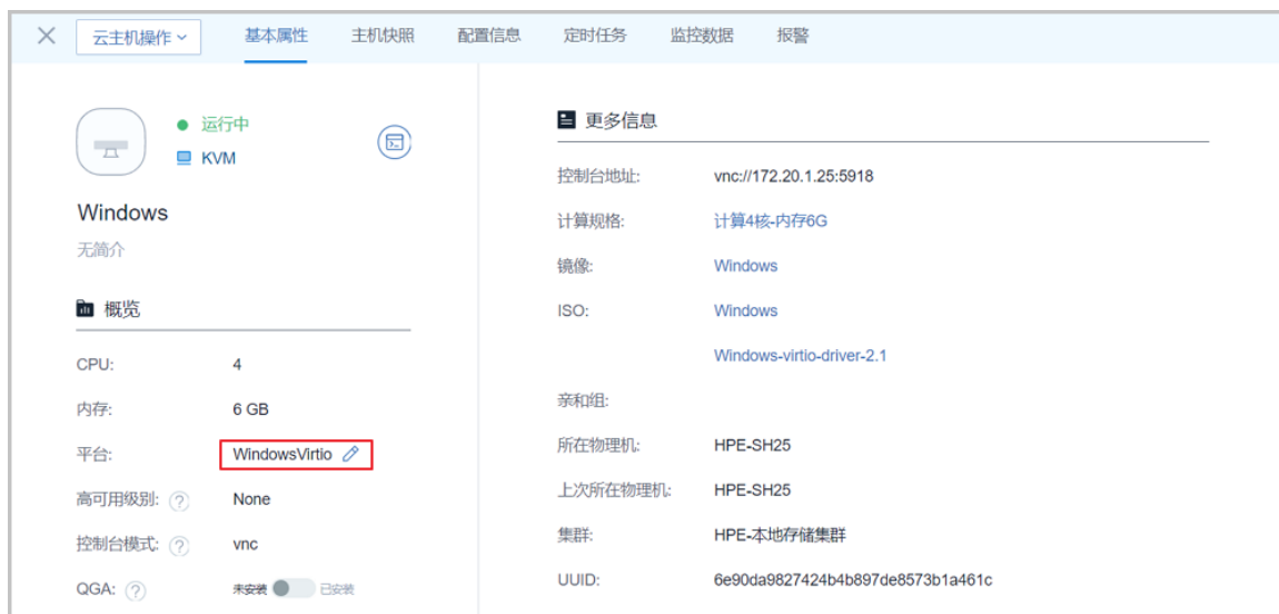
图 43: 平台切换为WindowsVirtio方式
